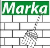
Limpiar el muro o superficie de imperfecciones y polvo donde se colocara la placa Marka
