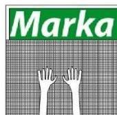
Coloca sobre el adhesivo una malla fina plastica presionando toda la superficie uniformemente
